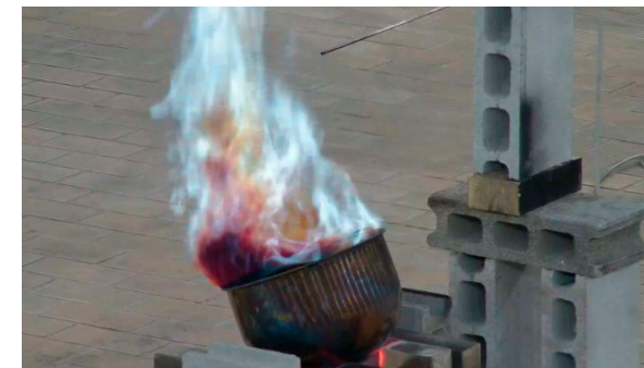
排煙処理設備の性能確認を目的とした硫黄燃焼試験の様子 撮影:NITE
