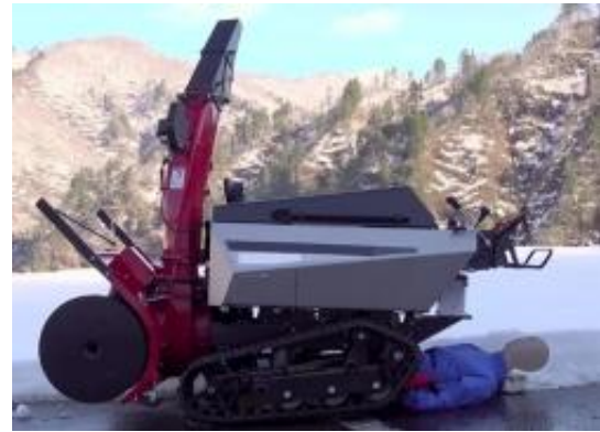
誤った使用により除雪機の下敷きになった様子
