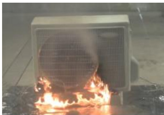
外火によりエアコン室外機が燃える様子
