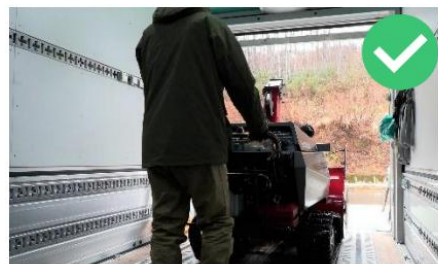
換気を確保して除雪機を移動させる様子
