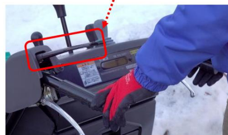
デッドマンクラッチ機構（安全機能）
