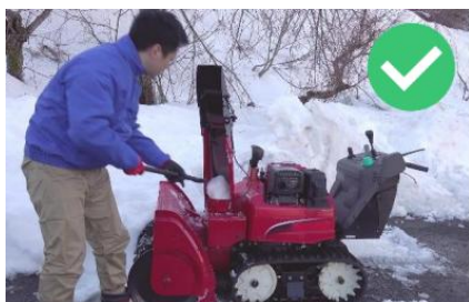
エンジンを切り、雪かき棒を使用して 詰まった雪を取り除く様子
