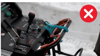
クラッチレバーを固定して 安全機能を無効化する様子
