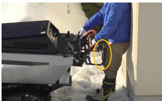
壁に挟まれた際に上部緊急停止バーが押され 後進が停止する様子
