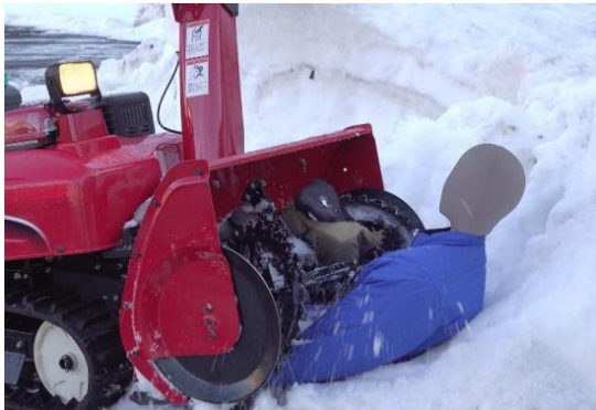
誤った使用により除雪機のオーガ（回転部）に巻き込まれた様子
