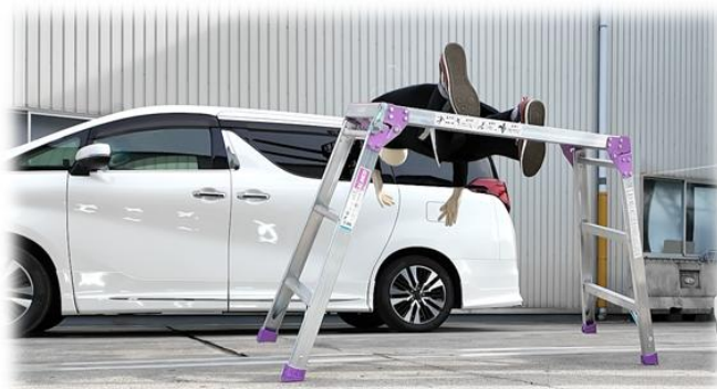
足場台から身を乗り出し バランスを崩し転倒する様子 （再現試験） 「撮影協力：アルインコ株式会社」
