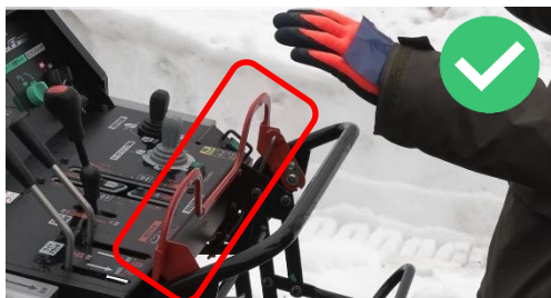
デッドマンクラッチ機構により 手を離すと停止する様子
