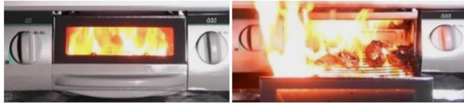
グリル庫内から発火（再現試験）
