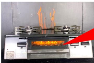
グリル庫内から発火し、後方のグリル排気口から炎が噴き出した様子（再現試験）
