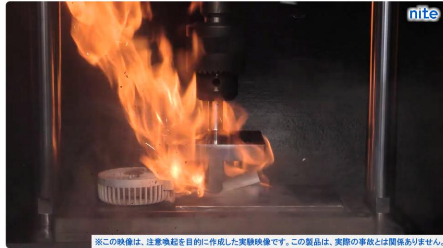
【事故再現】携帯用扇風機「2.ごみとして捨てて発火」
