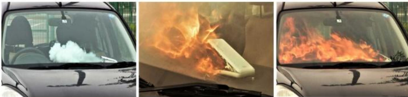
モバイルバッテリー 車内に放置して発火 (再現映像 撮影協力：株式会社 GENKI LABO、新潟市消防局)
