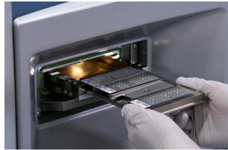
5. プレーートをMALDI-TOF MSへ、その後MALDI-TOF MSで測定、市販の解析ソフトで解析
