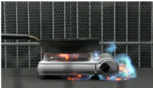
経年劣化したカセットボンベを使用 して漏れたガスに引火する様子 (イメージ)
