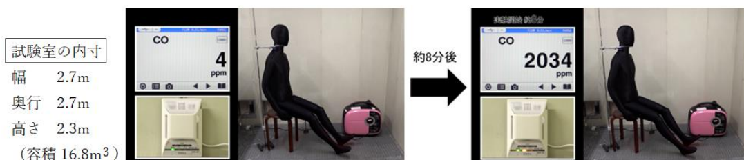
屋内で携帯発電機を使用した際の一酸化炭素（CO）濃度の変化
