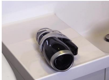
電源コードを強く巻き付けて断線 (例：ヘアードライヤー)
