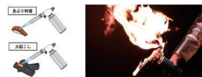
ガストーチの使用用途例とガス漏れして引火した再現映像 出典:NITEプレスリリース(事故原因の7割が製品に問題～ガス“漏れ”バーナーに新たな規制～) 令和7年2月27日
