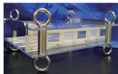
プラスチックの浸漬試験で使用する治具
