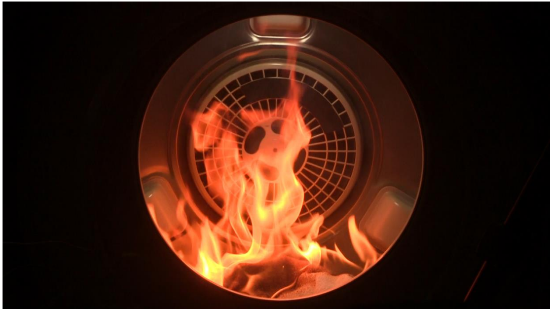
写真 アロマオイルが付着したタオルがドラム式洗濯機内で発火する様子
