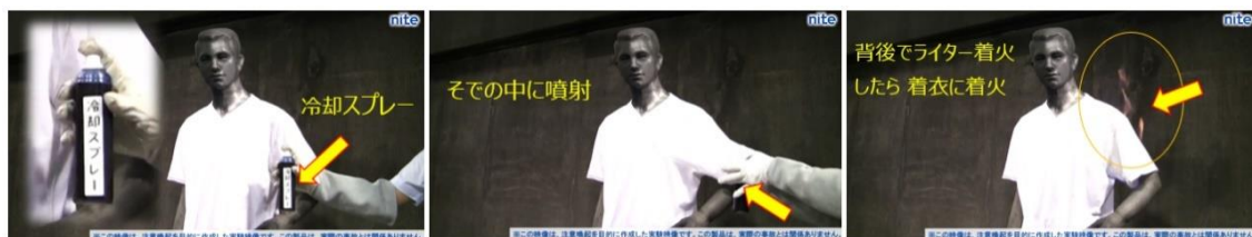
冷却スプレーを使用後にシャツに着火する事故の再現試験
