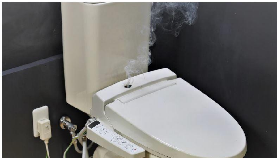
撮影協力：一般社団法人日本レストルーム工業会 経年劣化による漏水で発火し、焼損した温水洗浄便座（再現実験）
