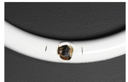
LED ランプの溶融（再現実験）
