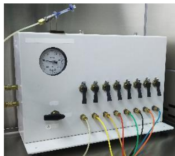
ガス置換装置 (安全キャビネット内で使用)
