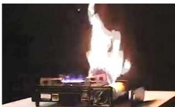
接続部から漏れたガスに引火して燃え上がる様子（再現実験）
