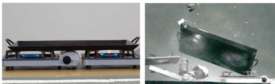
カセットコンロを2台並べて使用してカセットボンベが破裂した様子
