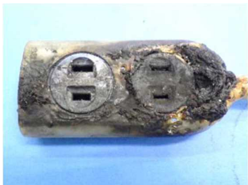
マルチタップの内部に水分が浸入
