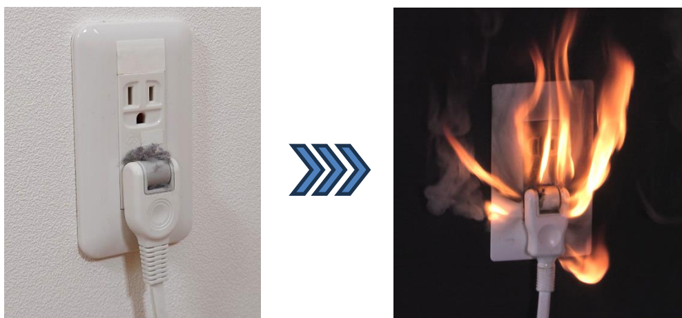
ほこり等の付着によりトラッキング現象 ※3 が生じてコンセントが発火
