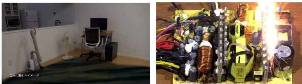
図4 浸水による通電火災のイメージ
