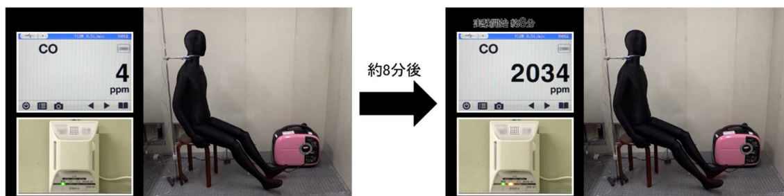
図2 室内で携帯発電機を使用した際の一酸化炭素(CO)濃度の変化
