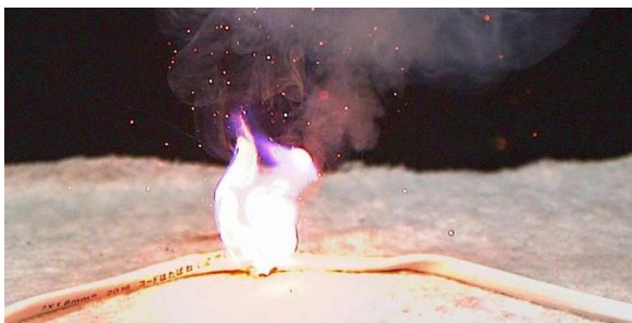
断線した電源コードの発火
