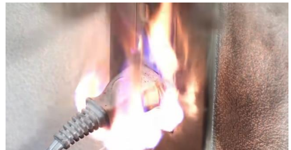
外力で破損した電源プラグの発火
