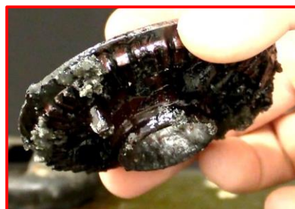
バーナーキャップの炎口が汚れて詰まっている様子
