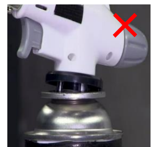
正しく接続されていない様子
