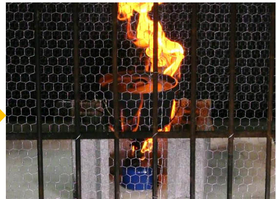
過熱されたボンベの接続部から漏れたガスに引火した様子
