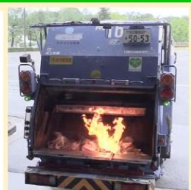
niteによるゴミ収集車での再現試験
