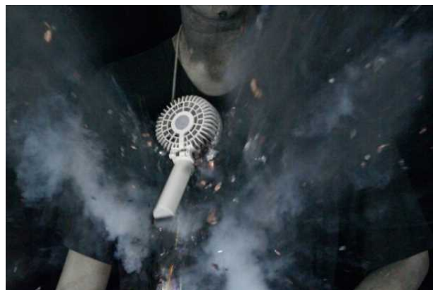
強い衝撃が加わり損傷したバッテリーが破裂
