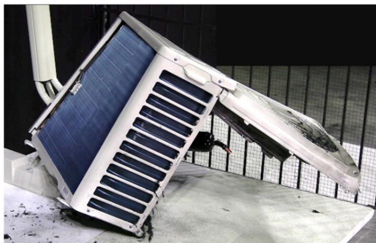
「無謀なDIY」による室外機の破裂
