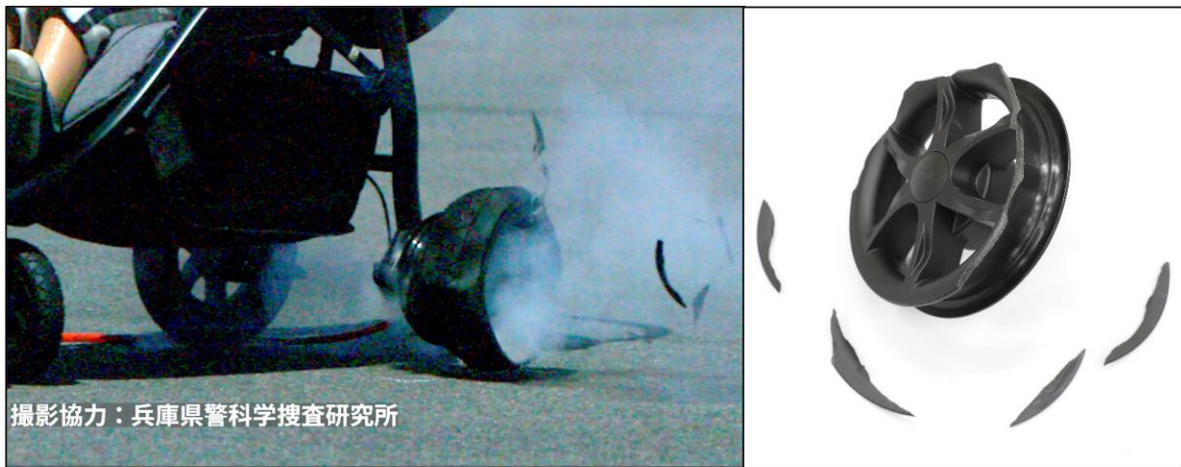
【実験写真】 使用者の空気の入れすぎによりタイヤが破裂し、車輪の破片が飛散
