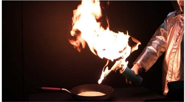
ガストーチから漏れたガスに引火
