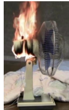
内部部品の経年劣化により発火する扇風機の再現映像
