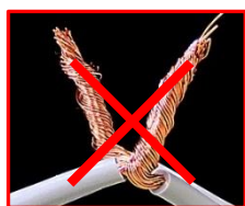
電源コードの継ぎ足し接続（ねじり接続）
