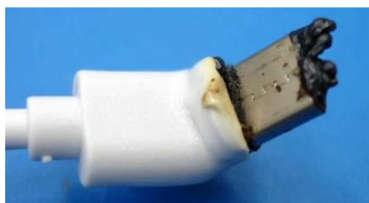
導電性の異物の付着により焼損したコネクタ（ケーブル側）
