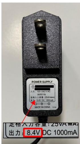
類似の形状でも出力電圧の異なる充電器（例）
