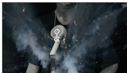
(写真) リチウムイオンバッテリーが破裂
