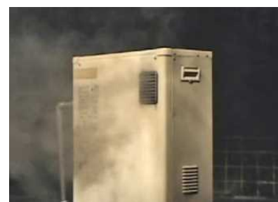
石油給湯機からの発煙（再現実験）
