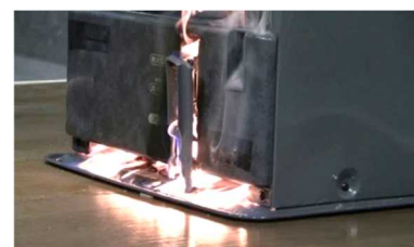
(写真) 再点火した際に、こぼれた灯油に引火 (イメージ)
