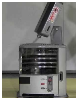
(写真) 消火後に燃焼筒の温度が高くなっており、灯油がかかり引火 (イメージ)
