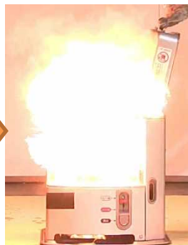
(写真) 消火後に燃焼筒の温度が高くなっており、灯油がかかり引火 (イメージ)
