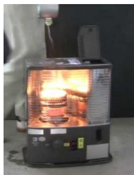
(写真) 消火せずに給油して、灯油が漏れ引火 (イメージ)
