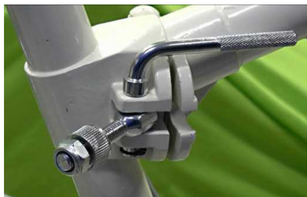
(写真) 折り畳みのボルトが緩んだ状態
