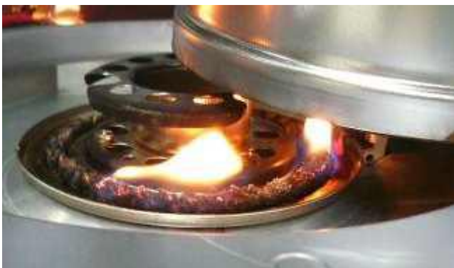
(写真) 芯が下がらず、消火不良となった芯式石油ストーブ
