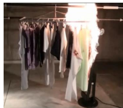
（写真）電気ストーブに衣類が接触して発火する様子（イメージ）
