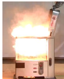
(写真) カートリッジタンクのふたが外れて灯油が高温部にかかり発火
