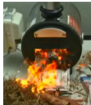
(写真) 焼却口から炎がこぼれて周囲の可燃物に着火する様子
