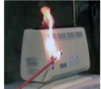
(図) 指定されたガス接続具を使用しなかったため、ガスが漏れて引火(再現実験)
