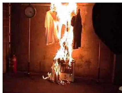
(図) 石油ストーブの上で干した洗濯物が落下して引火（再現実験）
