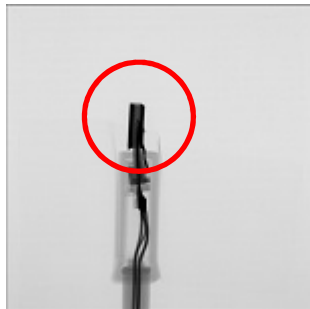
(左) 折り曲げ前のマイクロ USB の X 線写真
