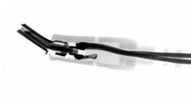
折り曲げたマイクロ USB の X 線写真。
