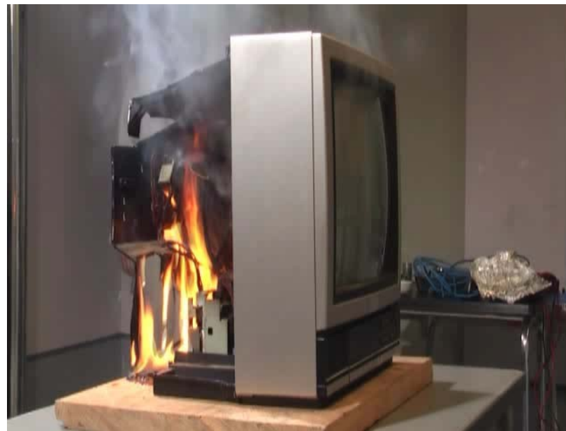
長期使用(約20年以上)により、フライバックトランスが絶縁不良となり発火したことの再現実験
