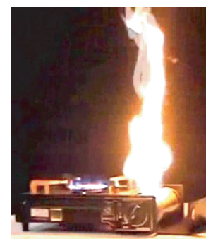
カセットボンベを正しく装着しなかったために漏れたガスが引火しました。(再現実験)
