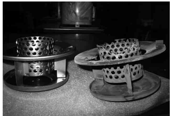
長期間の使用により、焼損や変形が見られる燃焼リング
