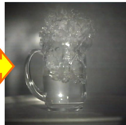
大きくなった 蒸気の泡が液 体（水）の表 面に達した瞬 間に破裂、液 体が周辺に激 しく飛び散る
